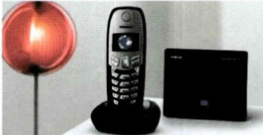
Siemens zeigte mit dem Gigaset C450 an der diesjährigen Cebit erstmals ein DECT-Telefon mit VoIP-Funktionalitäten. Das Hybridmodell hat an der Basisstation sowohl einen Festnetz wie einen LAN-Anschluss. Damit lassen sich die VoIP-Funktionen ohne einen PC realisieren.
